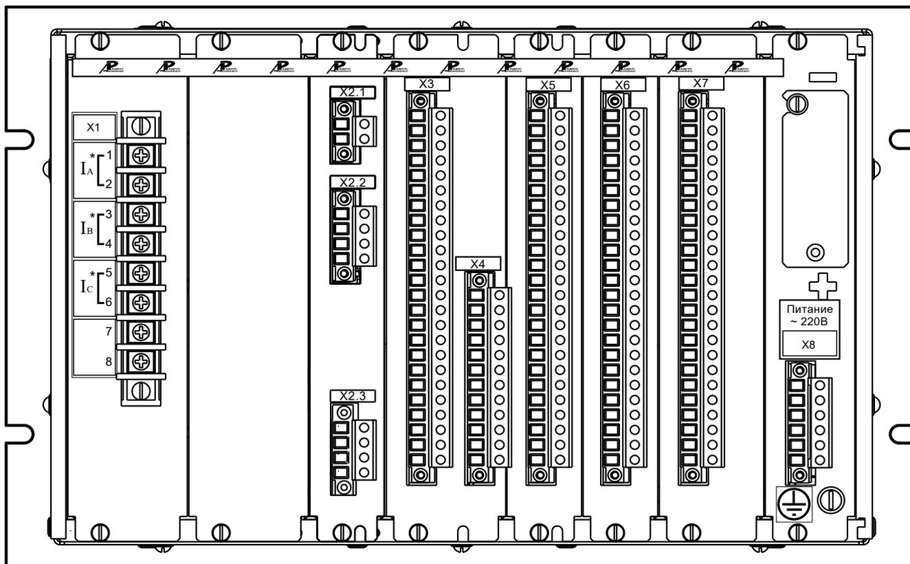
Рисунок Г.5 – Расположение элементов на задней панели устройства «Сириус-2-С»
