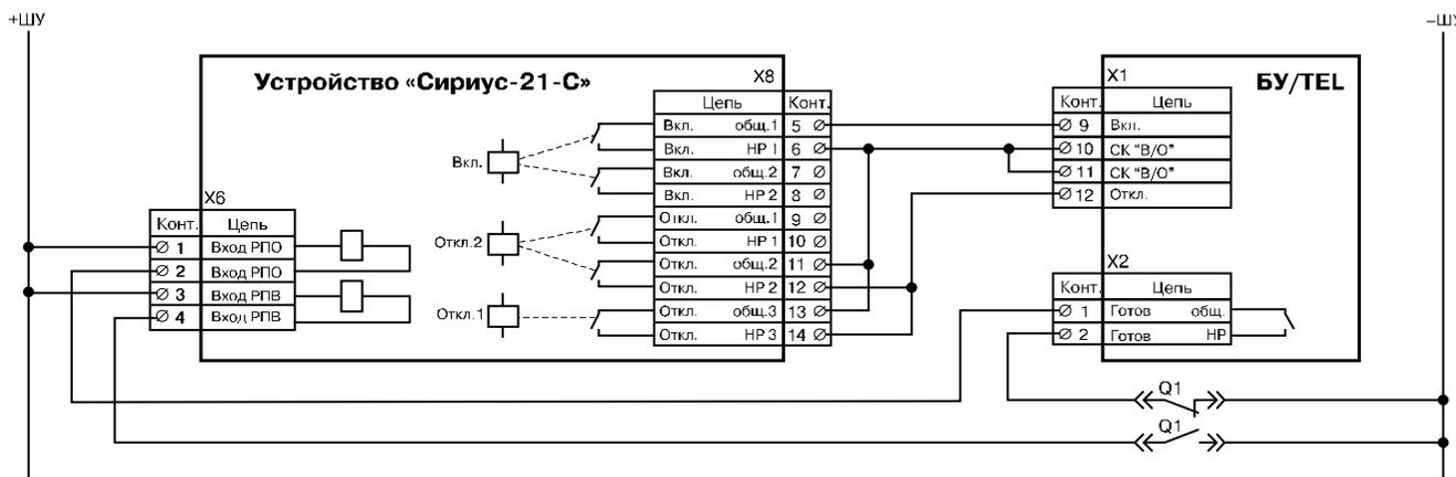
Рисунок Д.3 – Схема подключения устройства «Сириус-21-С» к выключателю ВВ/ТЕЛ с блоком управления БУ/ТЕЛ-12
