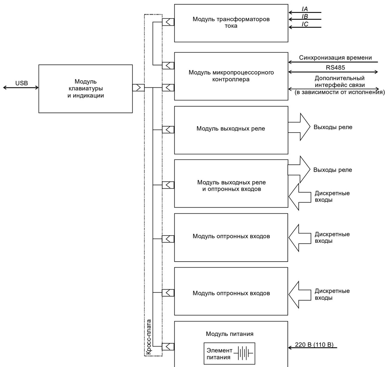
Рисунок 1 – Структурная схема устройства
