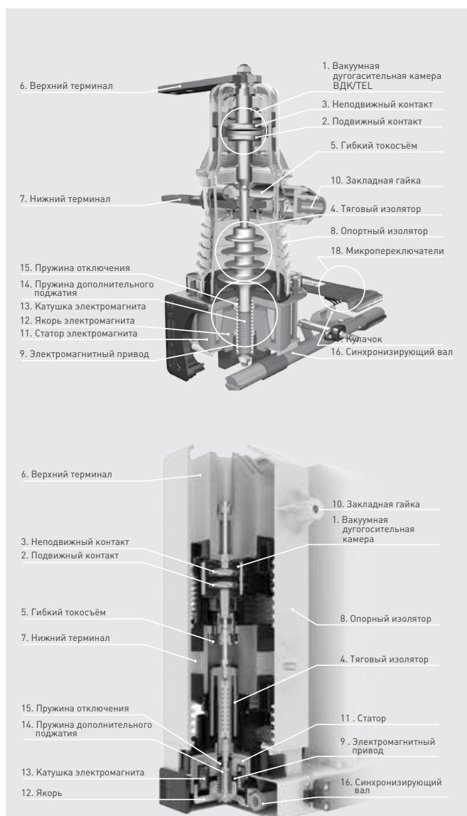
Рис. 7. Разрез полюса коммутационного модуля: сверху – ISM15_LD_1; снизу – ISM15_Shell_2
