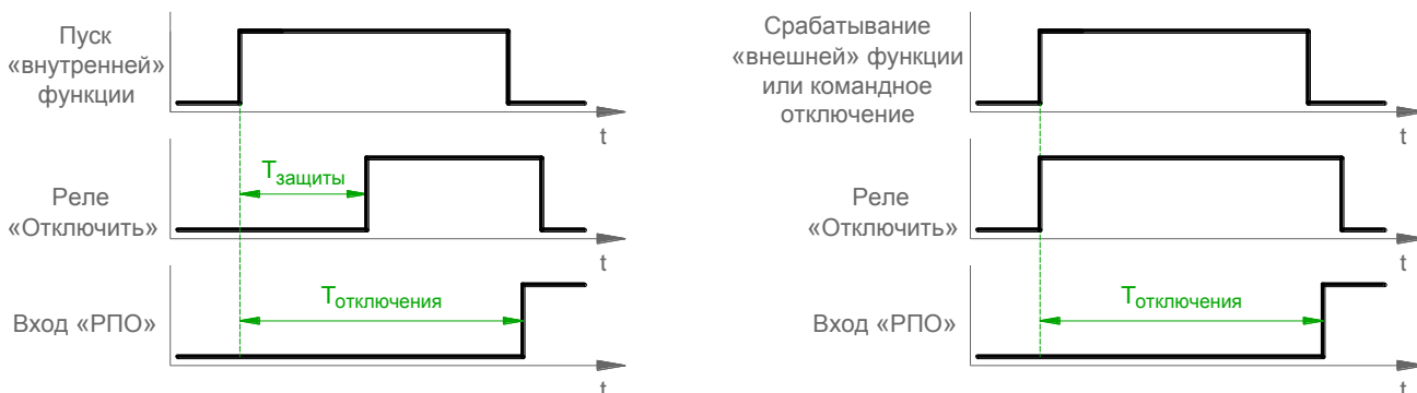
Рисунок 47 – Измерения времени срабатывания защиты и времени отключения выключателя
