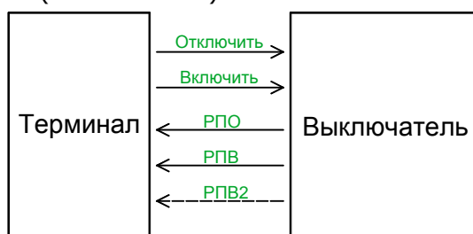
Рисунок 36 – Взаимодействие терминала и выключателя
