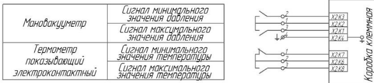
Рисунок Д.1 - Монтаж контрольных кабелей трансформаторов с термометром показывающим электроконтактным и мановакуумметром
