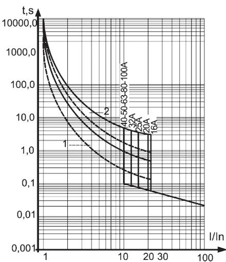
1 - зона работы теплового максимального расцепителя тока, снятая с холодного состояния;
