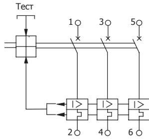
Автоматические выключатели переменного тока трехполюсного исполнения с независимым расцепителем и вспомогательными контактами (кроме BA57Ф31, BA57Ф35)
