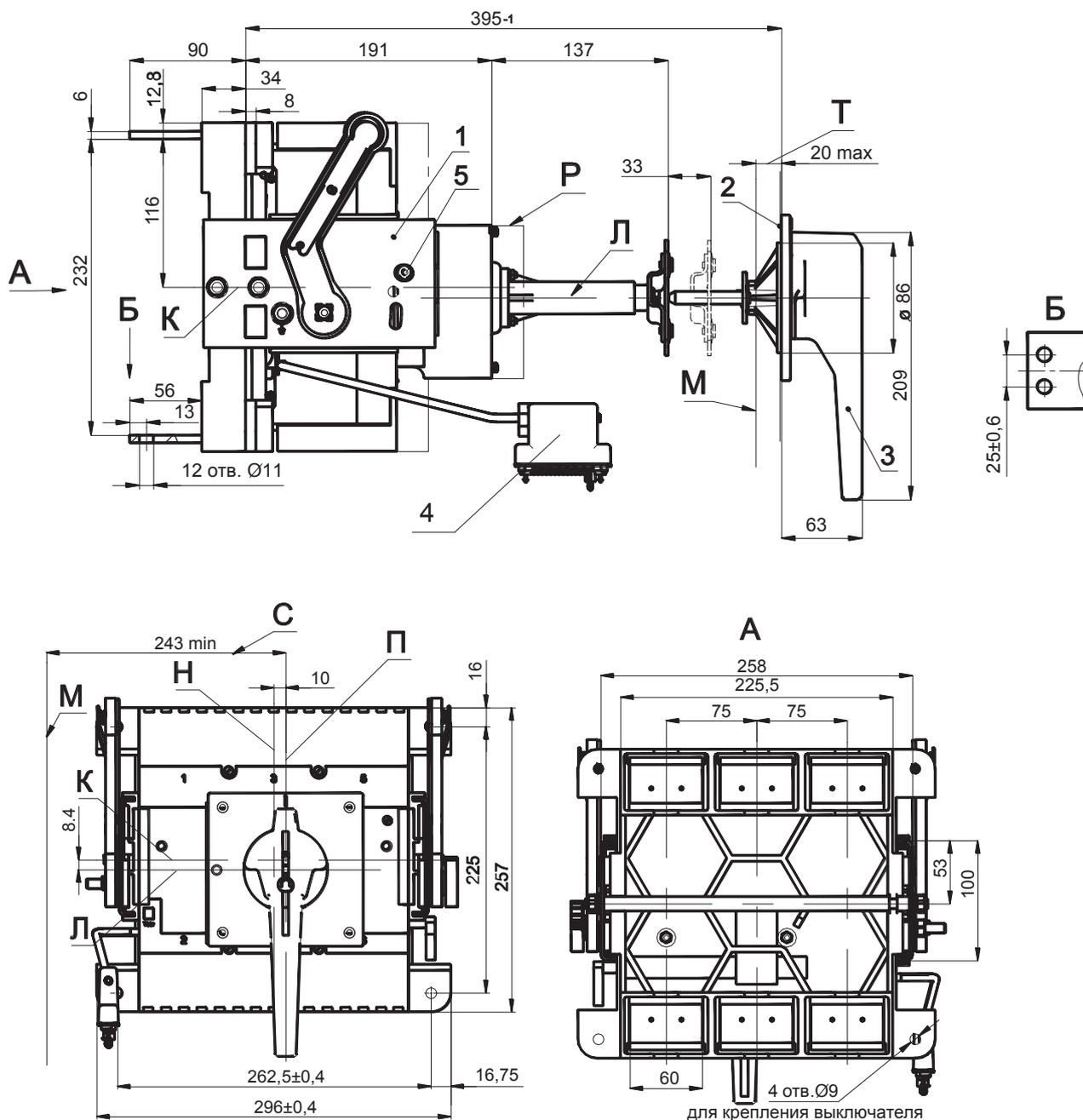
**Автоматический выключатель ВА57-39 выдвигного исполнения с электромагнитным приводом**
