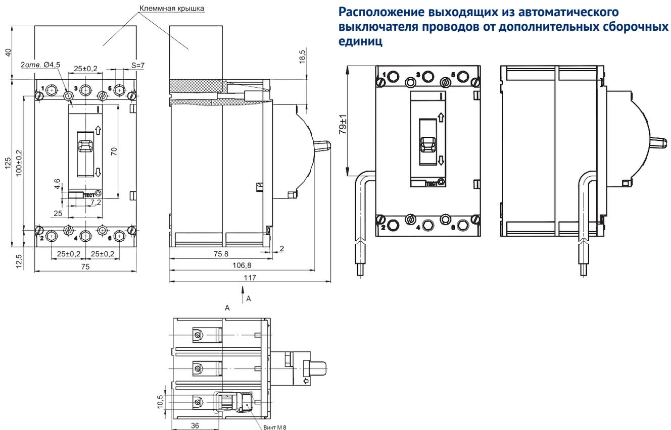
Расположение выходящих из автоматического выключателя проводов от дополнительных сборочных единиц
