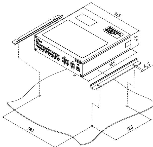
**Рис. 6.1.** Установка модуля управления на горизонтальной поверхности
