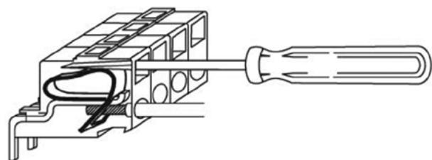
**Рис. 6.3.** Подключение проводника к соединителю WAGO
