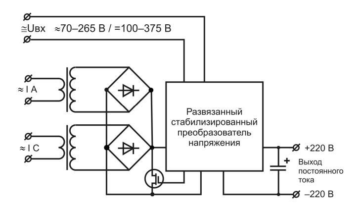
Приложение Б Схема подключения блока питания «Орион-БП-3» к внешним цепям
