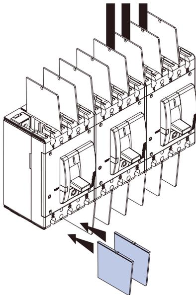
При монтаже нескольких аппаратов расстояние между автоматическими выключателями может равняться 0 мм, при этом необходимо установить разделитель полюсов
