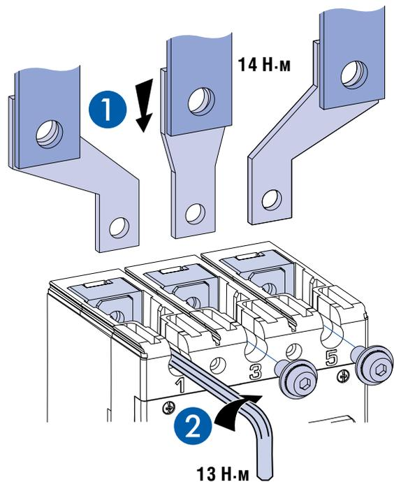
Дополнительные зажимы служат для присоединения к выключателю кабелей без кабельных наконечников. Зажимы крепятся непосредственно к контактным выводам аппарата (не входят в комплект поставки).
