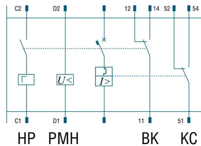
**Схема электрическая принципиальная контакта сигнализации**
