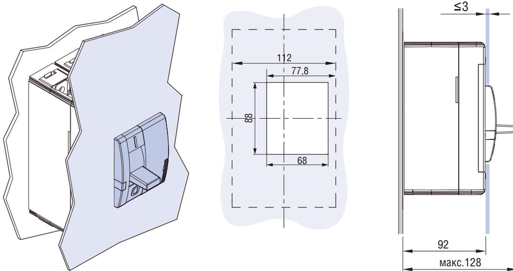
Автоматические выключатели устанавливаются в любом положении (горизонтальном, вертикальном на вертикальной плоскости и на горизонтальной плоскости (рукояткой вверх). При этом их рабочие характеристики остаются неизменными.
