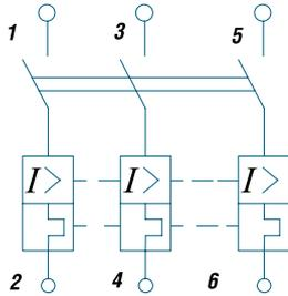
**Схема электрическая принципиальная выключателя с дополнительными сборочными единицами**
