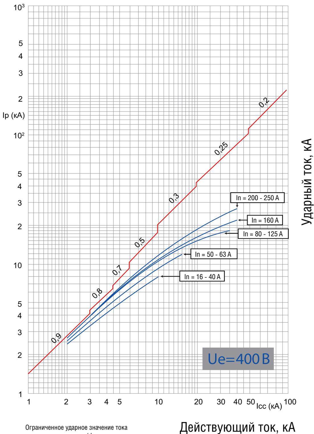
Ограниченное ударное значение тока короткого замыкания (фактическое максимальное значение) в зависимости от действующего значения ожидаемого тока короткого замыкания
